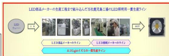
弊社は、光源から完成品迄の一貫生産ラインを有し、LED ベアチップの高密度実装・樹脂封止・組立が可能です。蛍光体調合や樹脂封止等のプロセス開発も可能で、光波長・色温度・平均演色性指数 Ra 等がカスタム対応できます。
