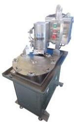
「鶏ボンジリ自動脱骨機」は手作業を機械化。作業効率が人力の 4~5 倍に向上した。
